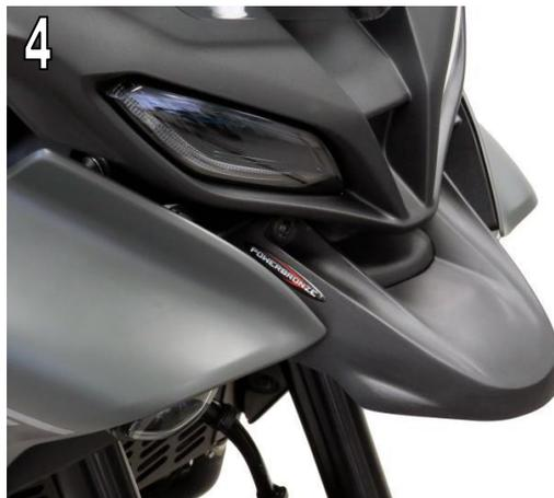
**WICHTIG: Überprüfen Sie regelmäßig die Ausrichtung des Schnabels und die Spannung der Befestigungsschrauben. / IMPORTANT: Always check alignment of beak and mounting bolt tension periodically.**
