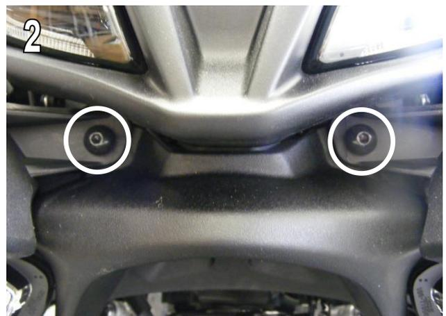
4. Befestigen Sie den Schnabel (1) mit den M5x40 Schrauben (2), Unterlegscheiben (6) und Distanzen (3) am Motorrad, wie in Abb.3 und Abb.4 gezeigt. / Fit beak (1) to bike using M5x40 screws (2), washer (6) and spacers (3) as shown in Fig.3 and Fig.4
