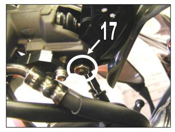
2. Demontieren Sie am Kupplungshebel den originalen Gummistopfen (siehe Bild links). Montieren Sie dann die Distanz (15) und den Halter (2) auf diesem Adapter und fixieren Sie den Halter mittels der M10x15 Inbusschraube (16).
