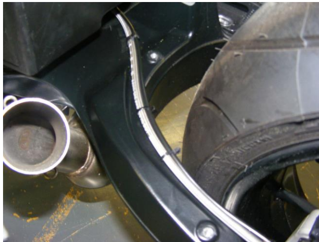
Bild1: Befestigung mittels Kabelbinder
